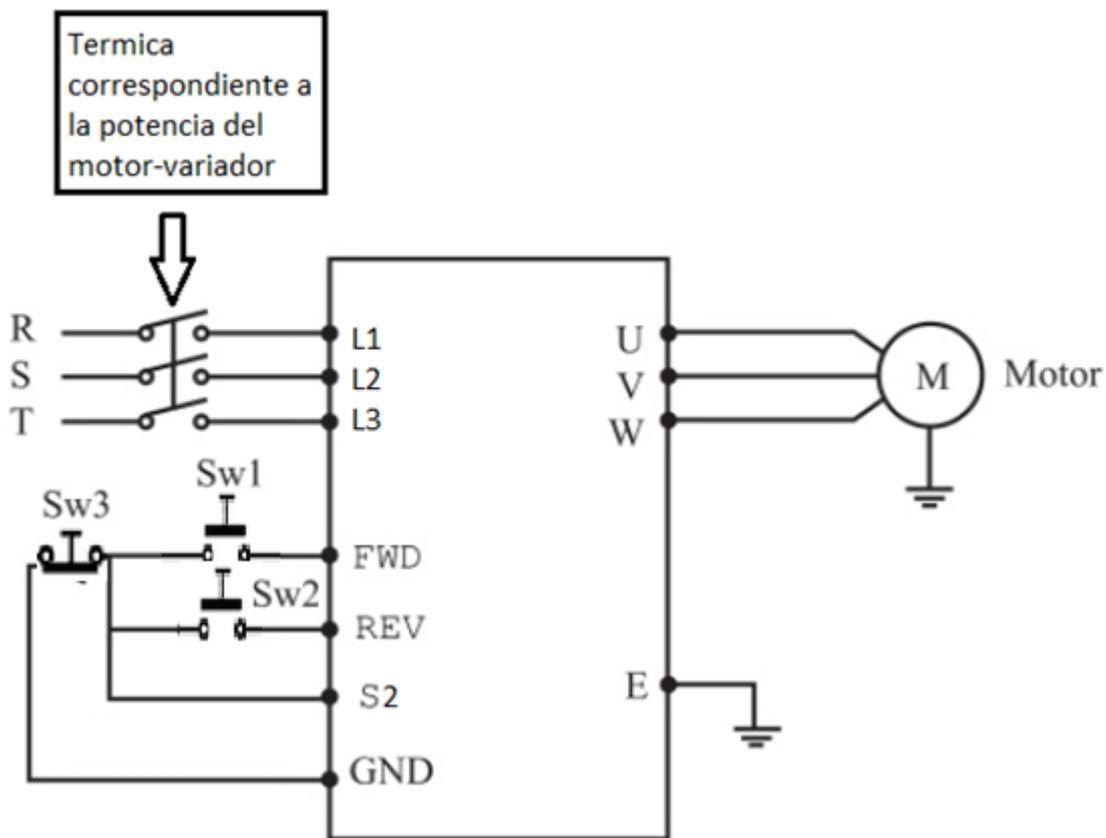
Nota: \*el sentido horario y anti-horario depende de cómo conecte los bobinas del motor al variador.
